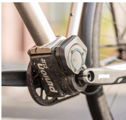
Die E-Pinion ist 600 Prozent gespreizt und liefert zwölf fein abgestufte Gänge.
