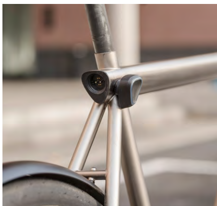
Hinterm Rücklicht in der Verlängerung des Oberrohrs verbirgt sich die Ladebuchse.
