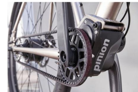
Links: Der Zahnriemen am Hinterradmotor hält 20.000 km. Für den Wechsel gibt es eine Rahmenöffnung (Pfeil). Oben: Das Pinion-Getriebe
