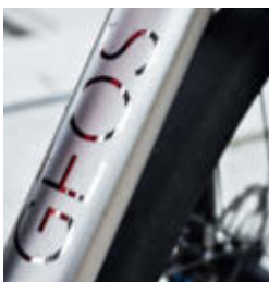
Der Stahlrahmen wird acht Stunden in ein Nickelbad getaucht, dadurch entsteht diese besondere Optik und die Oberfläche ist sehr kratzfest
