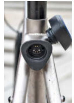
Die Ladebuchse befindet sich am Ende des Oberrohrs, die magnetische Abdeckung ist gleichzeitig das Rücklicht
