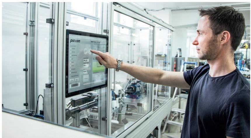
Jedes einzelne Pinion-Getriebe durchläuft ein aufwändiges Prüfverfahren. Seit 2015 zusätzlich zu den manuellen Tests auch am vollautomatischen Serienprüfstand.
